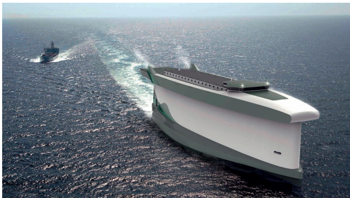
Das „Vindskip“ unterscheidet sich radikal von traditionellen Schiffsentwürfen – der Rumpf selbst erzeugt den Vortrieb, Foto: Terje Lade/LadeAS
