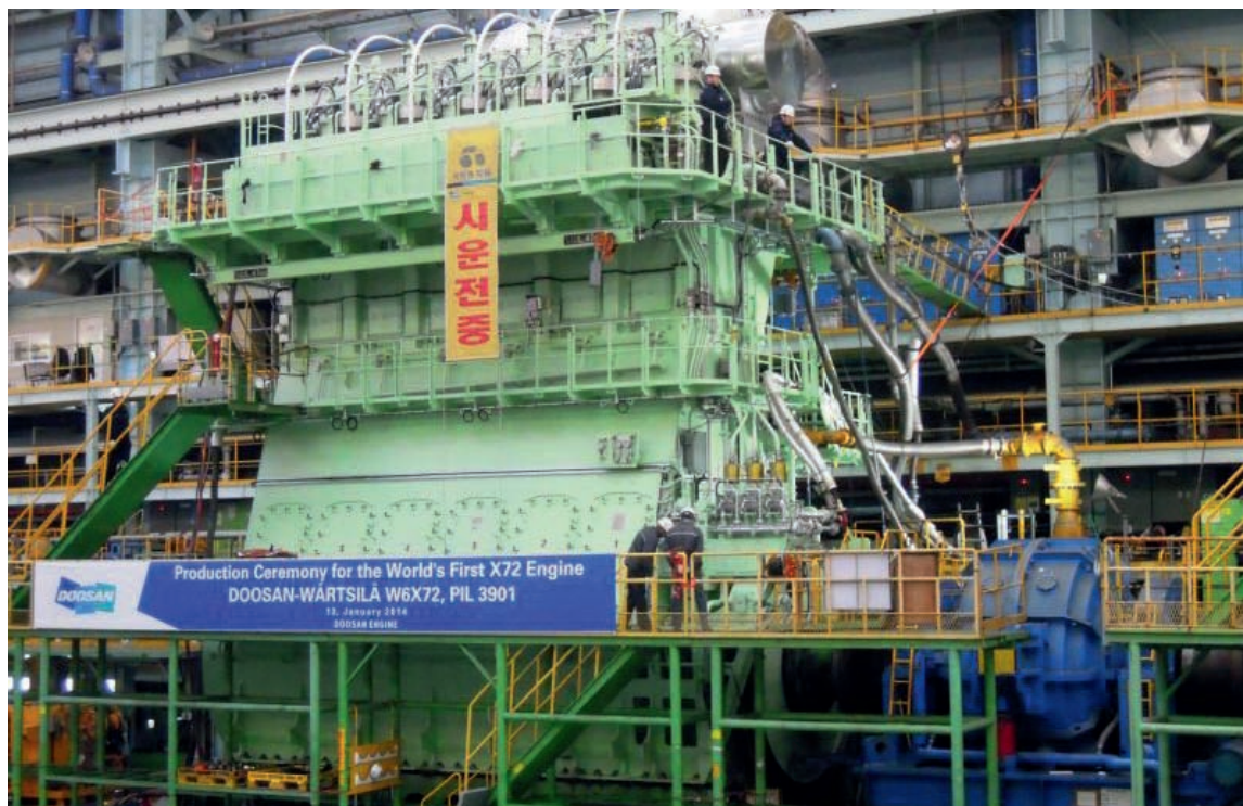
Wärtsilä/X72-Motor - die Verbrauchsdaten der haushohen Hauptmaschine kann wichtige Erkenntnisse für die zukünftige Schiffskonstruktion liefern
